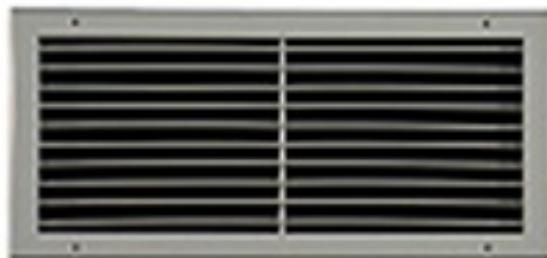
Алуминиумска решетка за потис или одсис на воздух која може да се постави на кружен канал (спиро канал), со еден ред фиксни ламели под агол од 45 °, паралелни со првата дадена димензија. Со дампер за регулација на протокот на воздух.
